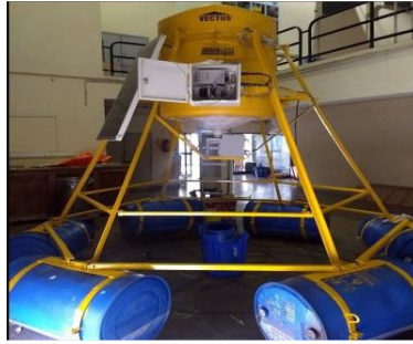
खुले समुद्र में तैरते मछली पिंजरों के लिए स्वचालित मछली फीडर
